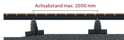
VARIO FIX mit Konstruktionsbalken 80 x 60 mm
